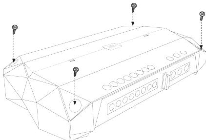
**IMPORTANTE:** Desconecte el terminal negativo (-) de la batería del vehículo antes de empezar la instalación.
