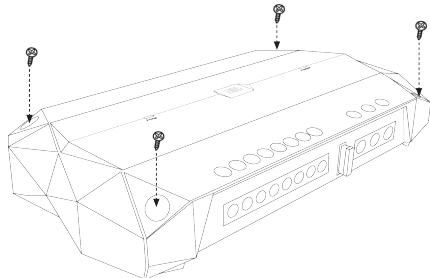
**IMPORTANT :** débranchez la borne négative de la batterie (-) du véhicule avant de commencer l'installation.
